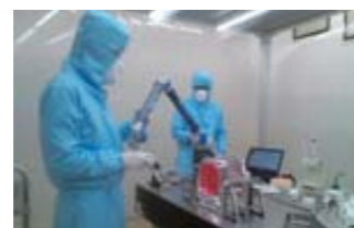
鏡の耳を接合する作業:富山大学理学部のクリーンルーム内で行っています。KAGRAの鏡に耳を接合しています。接合するときに埃が入ってはいけなないのでクリーンルームの中で写真のような特殊な服を着て作業しています。
